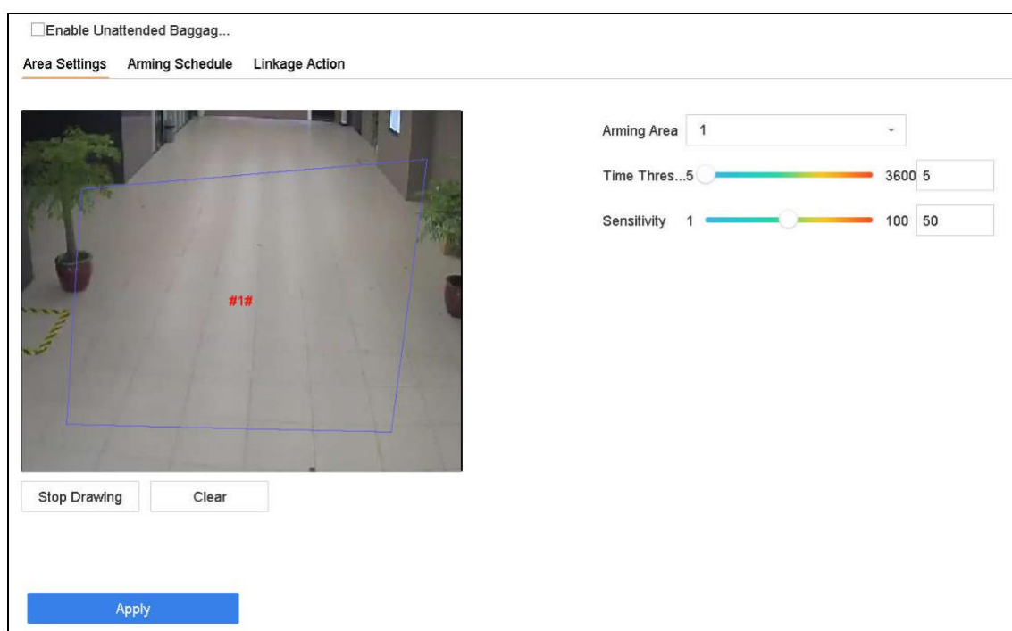
Rysunek 13-8: Detekcja bagażu pozostawionego bez nadzoru
